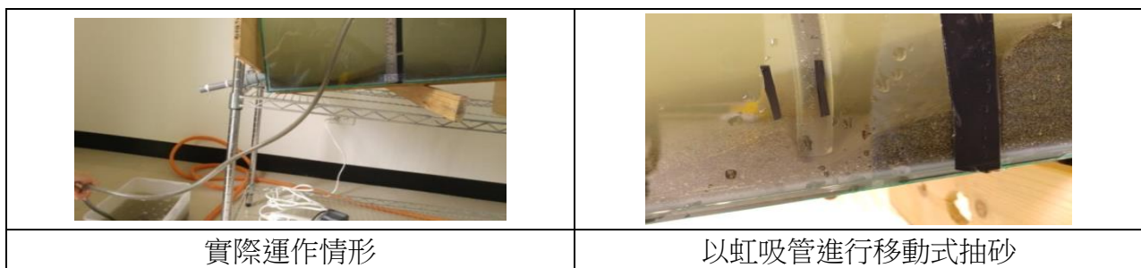
【圖 21】移動式虹吸排砂實際運作情形
