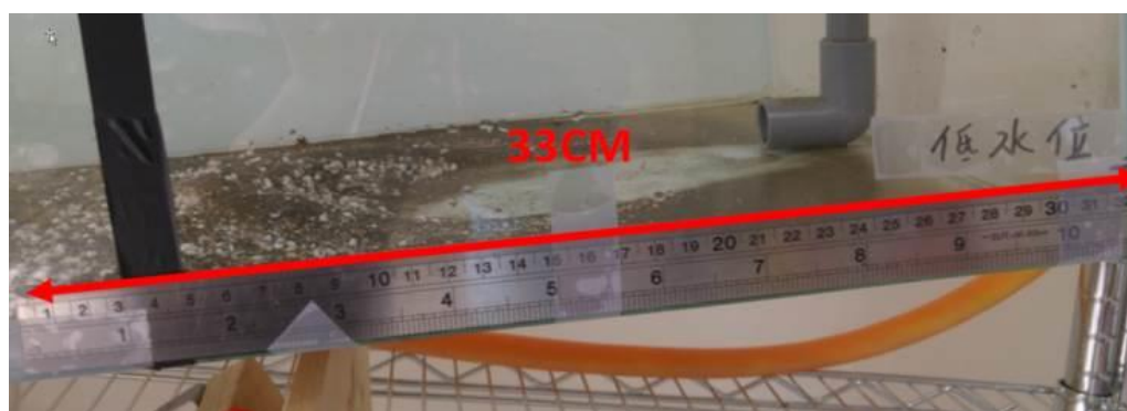
【圖 26】坡度 5 度時頂坡距水槽右側 33cm
