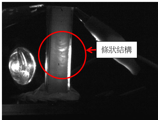
圖六 施加電壓後二氧化矽粒子的排列情形
