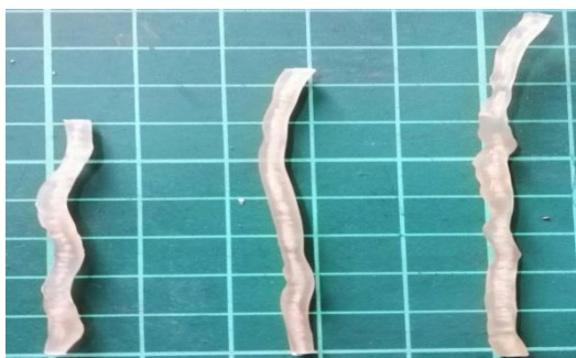
圖(8) 聚乳酸(PLA)加熱後射出長條形
