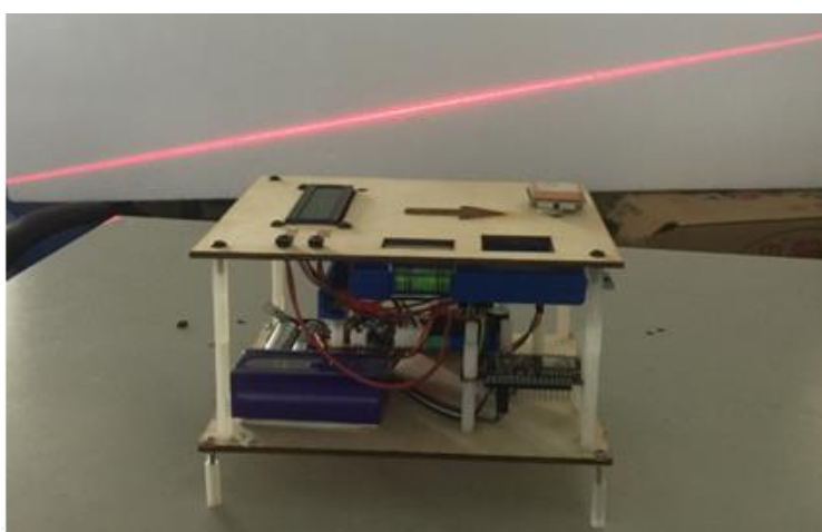
圖 3-10 固定型太陽能板最佳架設傾斜角標示儀，(a) 系統方塊圖，(b)俯視圖，(c)工作時照片
