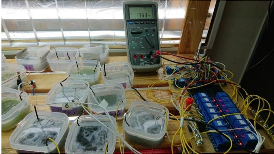
圖九、PROVA 803 digital multi-meter 與 16 路時控繼電器模組運作狀況
