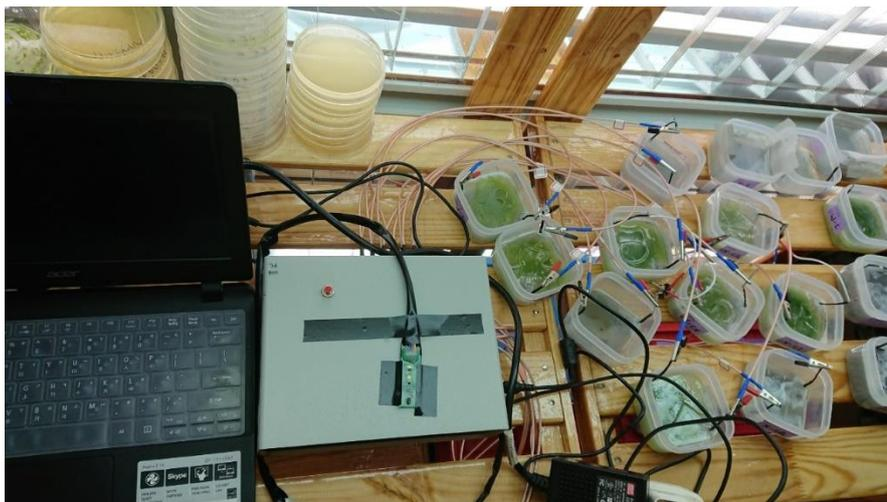
圖八、十通道微電壓量測儀運作狀況
