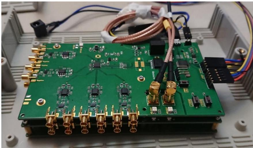
圖七、十通道微電壓量測儀
