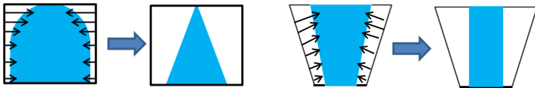
▲圖 14：角錐狀匯聚組(左)及圓柱狀匯聚組(右)結冰方向示意圖
