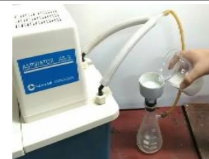
步驟 1-6 抽濾各個 pH 值的溶 液
