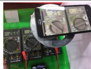
步驟 1-8 紀錄 放電電壓即放電電流
