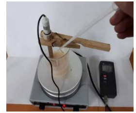
步驟 1-4 架設 pH 計監測其 pH 值
