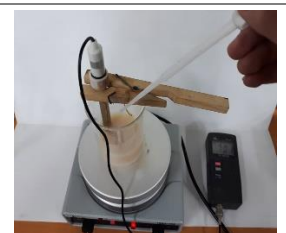
步驟 1-4 架設 pH 計監測其 pH
