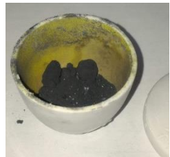
步驟 5-8 拆開黏土取出碳材 準備酸洗
