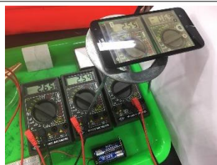
步驟 1-6 紀錄 充電電壓及充電電流
