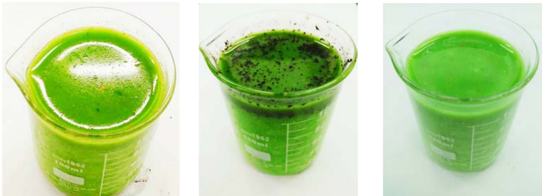
圖 58 由左至右分別為未經吸油處理之剩食、加入磁性化花生殼粉進行吸油處理之剩食、 經吸油處理完之剩食
