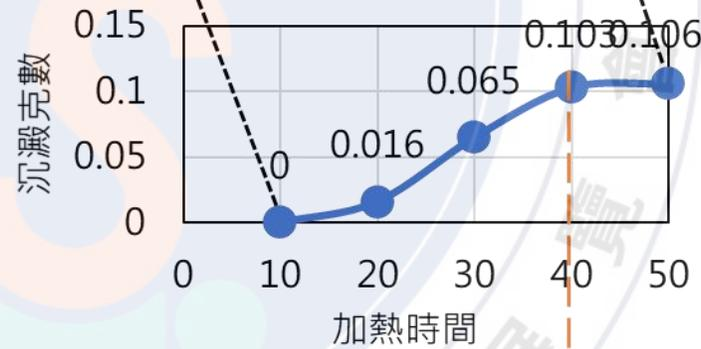
【圖】過氧化鈦水溶液經 $80^\circ C$ 加熱不同時間時的沉澱量
