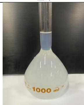
【圖】 千分之一倍稀釋的硫酸鈦檢測液產生混濁
