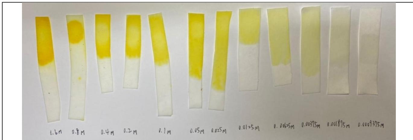
【圖】浸泡檢測液(硫酸鈦原液的 1/10)所製成的試紙上滴加不同濃度雙氧水(1.6 M、0.8 M、0.4 M……0.00375 M、0.001875 M、0.0009375 M)
