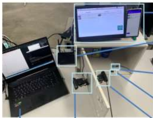
Server 辨識食品軌跡、紀錄食品清單並提供冰箱與APP與所需資料。 Camera 1 新增食品類別擷取影像。 Camera 2 辨識食品與移動軌跡。 溫溼度感測器 偵測冰箱內溫度。 微動開關 偵測冰箱門開關。 路由器 樹莓派、APP與Server連線之媒介。 觸控螢幕&手機 樹莓派與APP的顯示介面。
