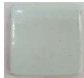
圖 17 微波燒製瓷土
