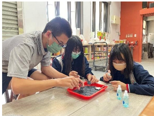
使用不同比例高溫澆水以噴塗的方式沾黏碳化矽製作實驗試片
