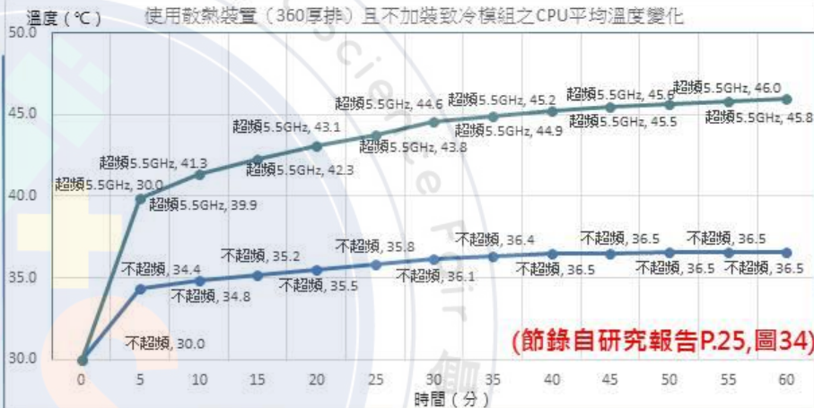
使用散熱裝置 (360厚排) 且不加裝致冷模組之CPU平均溫度變化
