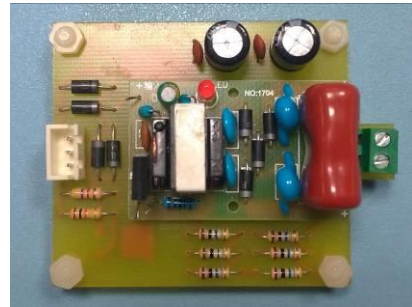
圖 19 第 2 代修正改良主控板與完工高壓電擊板
