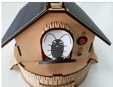
圖 36 提示窗平時關閉(左圖)當捕獲將會被推開(右圖)
