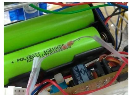
圖 31 並聯電阻降低靈敏度
