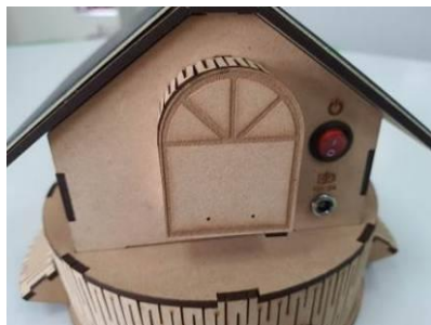
圖 36 提示窗平時關閉(左圖)當捕獲將會被推開(右圖)
