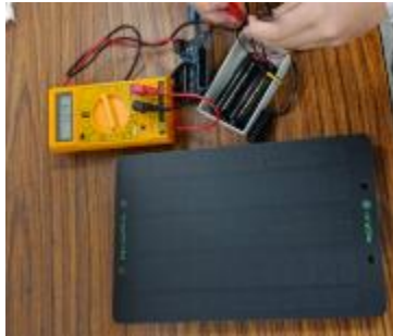
圖(九) 檢測太陽能板輸出電壓
