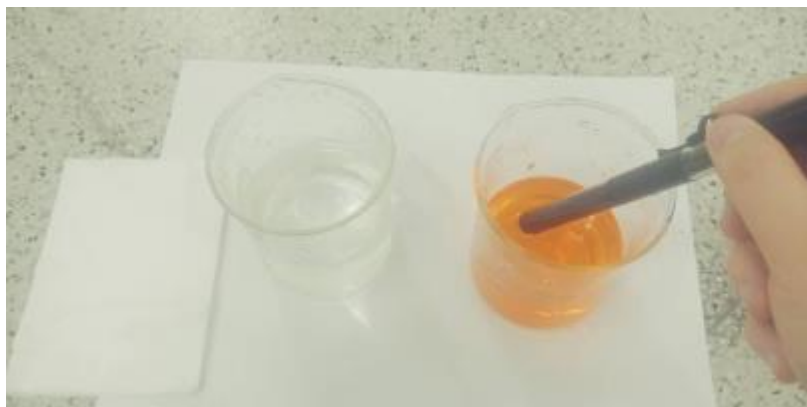
圖(十三) 校正 pH 質感應電極
