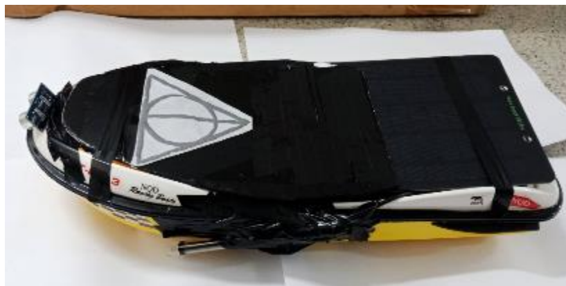
圖(二十九) 太陽能/行動電源藍芽遙控船
