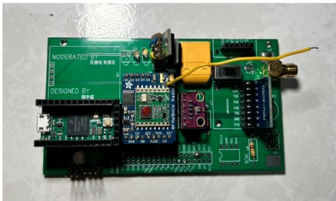
圖（二十四）自行開發航電系統MK5 （圖片來源：自行拍攝）
