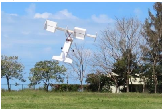
圖 37 飛行時受到左側風影響導致機身傾斜
