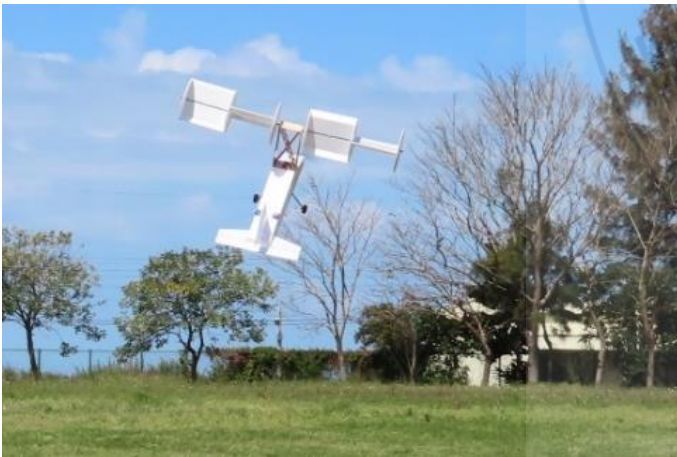
加速度計陀螺儀自動保持穩定
