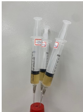
圖三 將針頭插入橡皮塞，觀測醱酵作用產氣量
