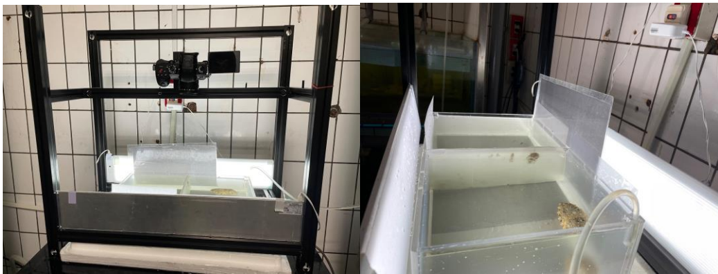
圖三：實驗設備。左圖為實驗完整裝置圖，右圖為實驗用壓克力水箱。
