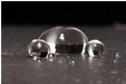
圖 1、萊頓弗羅斯特現象 Leidenfrost effect 的液滴型態
