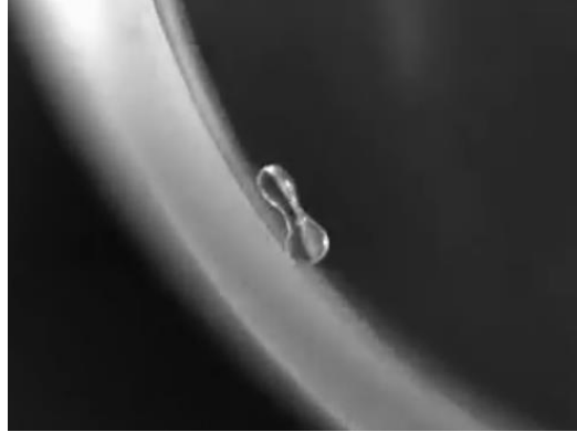
圖 34、甘油與水 1:1 混合：液滴易發生形變，無法穩定懸浮
