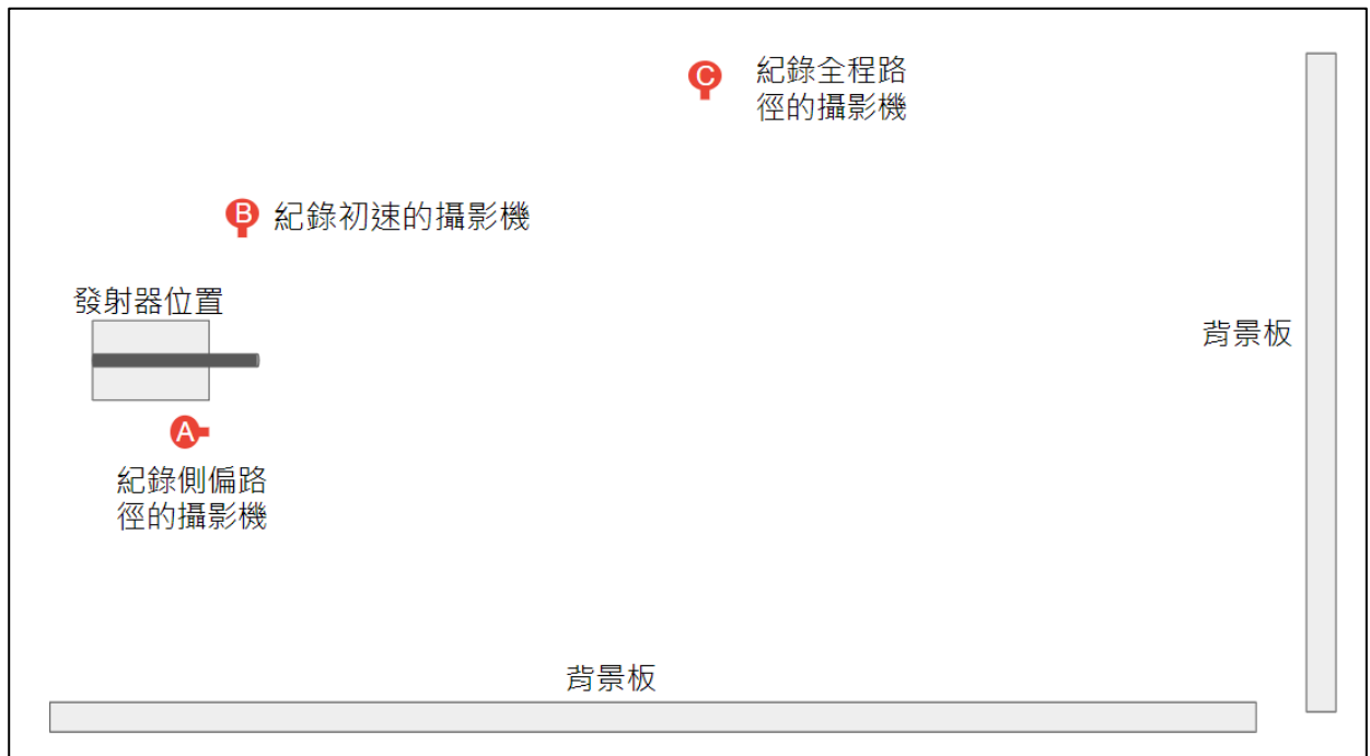
圖十、實驗的三台攝影機的架設位置示意圖。A攝影機於發射處偏右處拍攝飛行器的側向偏移，B攝影機記錄飛行器初始的飛行，C攝影機從側面紀錄飛行器全程的移動。
