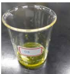
【圖】使用赤、黃血鹽來檢驗炭電極鋼片對溶液通電0.5 V後溶液內離子變化
