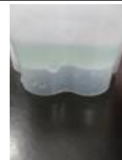
【圖】通電 60 秒的溶液加入黃血鹽
