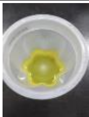
【圖】通電 20 秒的溶液加入赤血鹽
