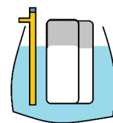
【圖】夾鏈袋電極示意圖
