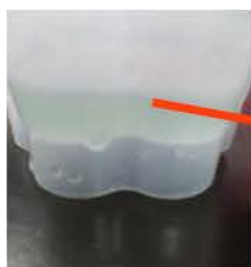
【圖】使用赤、黃血鹽來檢驗炭電極鋼片對溶液通電0.5 V後溶液內離子變化
