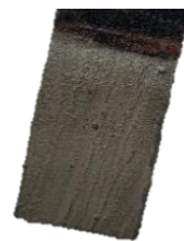
圖 28、鍍鐵導電碳板。
