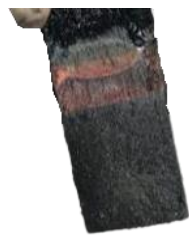
圖 27、鍍不均勻的鐵電極。
