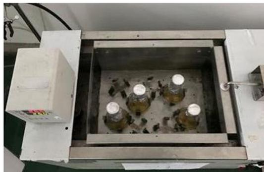
(圖十五) 錐形瓶置入震盪式恆溫水槽中搖晃
