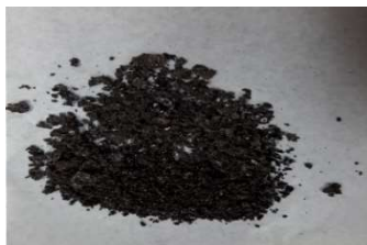
圖十七、片狀幾丁聚醣從粒子表面上剝落
