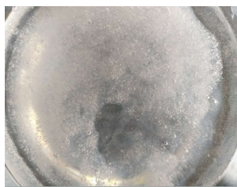
圖十六、 幾丁聚醣醋酸水溶液噴灑至氫氧化鈉水溶液，產生毛絨狀固體之幾丁聚醣析出(此水溶液中不含 \text{Fe}_3\text{O}_4 磁性粒子)
