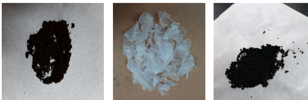
圖十、(左)純 \text{Fe}_3\text{O}_4 磁性粒子；(中)純幾丁聚醣碎片；(右) \text{Fe}_3\text{O}_4 /幾丁聚醣磁性粒子
