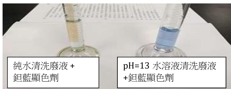
圖十四、清洗 \text{Fe}_3\text{O}_4 /磷酸二氫根磁性粒子後，清洗廢液混合鉍藍顯色劑
