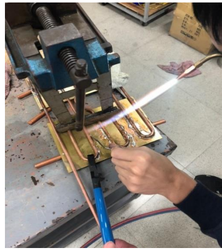
圖 17 散熱盤管接上散熱銅板
