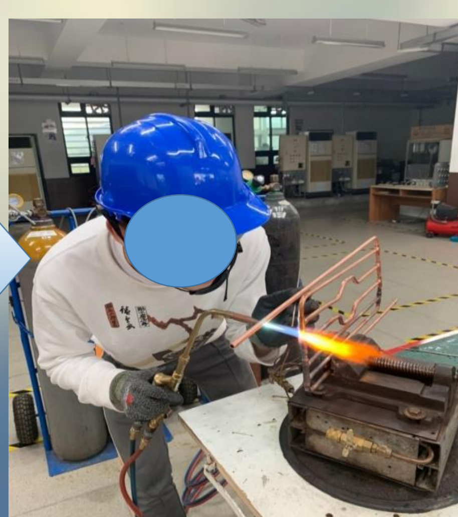
散熱盤管焊接
