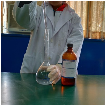
圖五 使用分度吸量管製備硫酸水溶液
