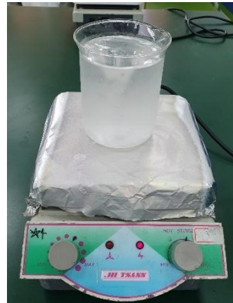
圖六 使用陶瓷檯面攪拌器製備硫酸水溶液
