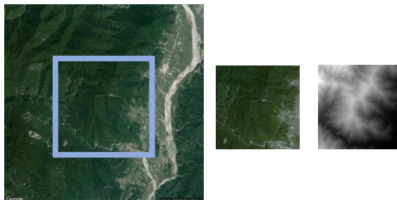
圖十、API 回傳之空照圖、裁切後的空照圖及該位置的高度圖。
