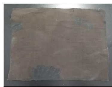
圖 15-3、於空氣碳電極背面 塗覆防水塗料
