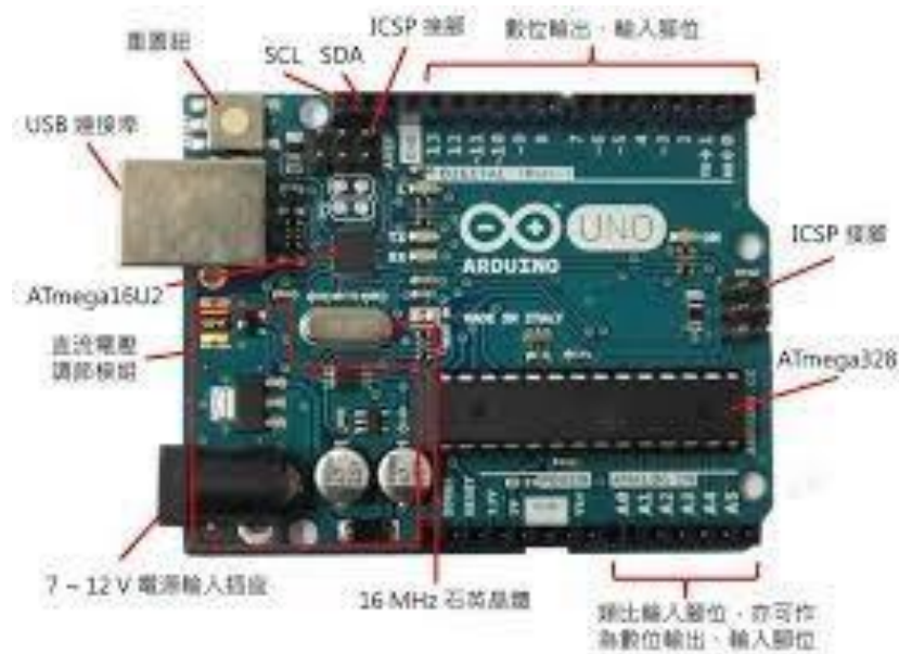
圖(3)ArduinoUNO 的模組框圖
