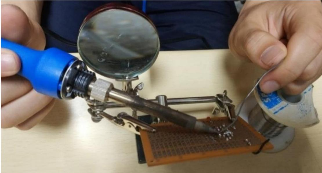
圖四 焊接電路板
