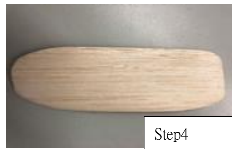
圖二十八 利用砂紙將葉片磨成翼剖面形狀
