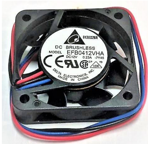
圖 11. 4.0×4.0cm 散熱風扇:
