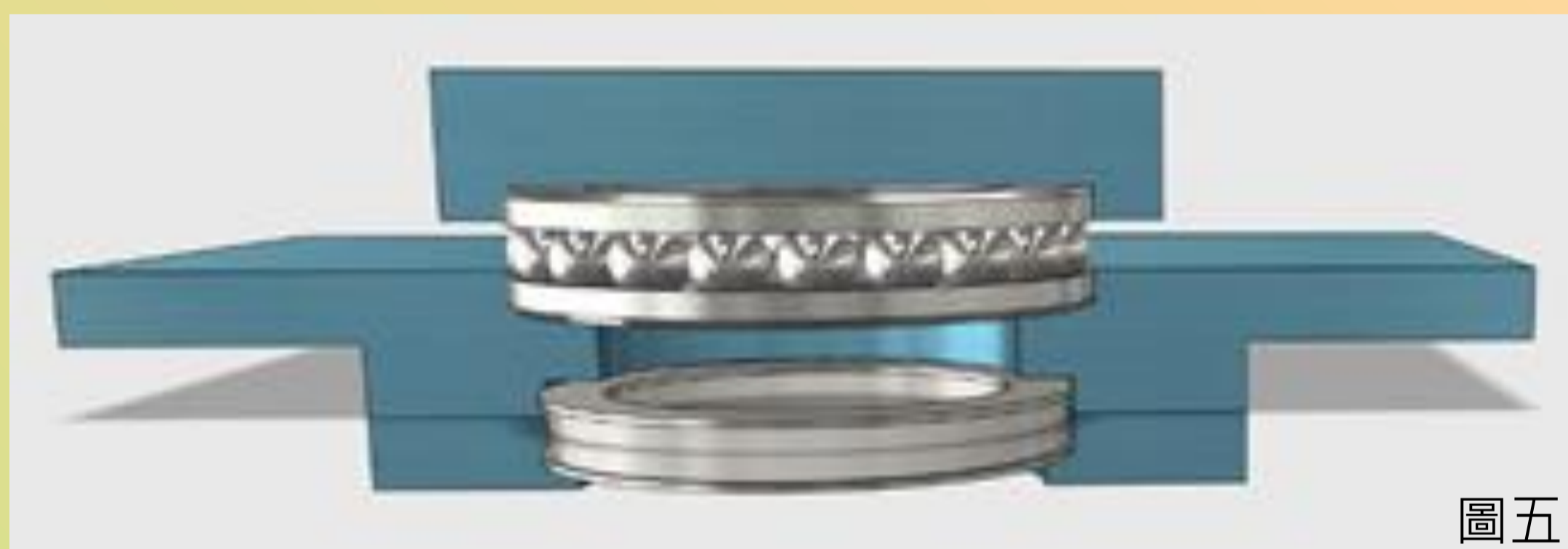
軸心固定裝置 剖面圖(圖七)
