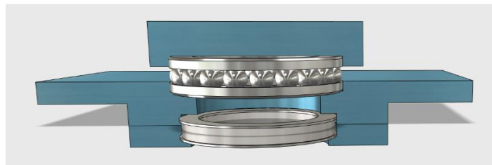
圖 18.軸承固定裝置(剖面圖，金屬色部分為軸承)
