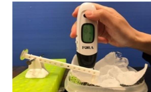
圖8. 膠原蛋白凍阻尼震盪恆溫裝置
