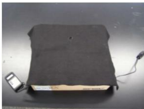
圖二 自製比色計之實際操作狀況
