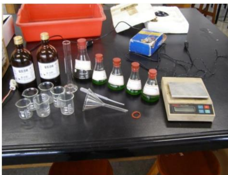
圖一 透光度實驗的器材、設備及裝有冷萃取液之錐形瓶
