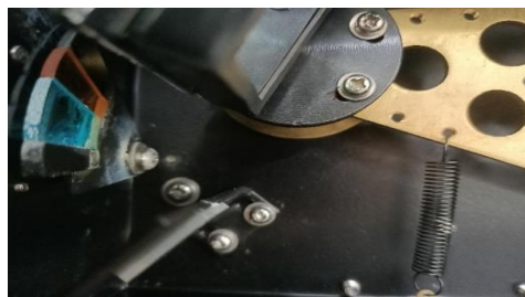
圖 28. 準直鏡、射出狹縫元件圖 (本研究設計)
