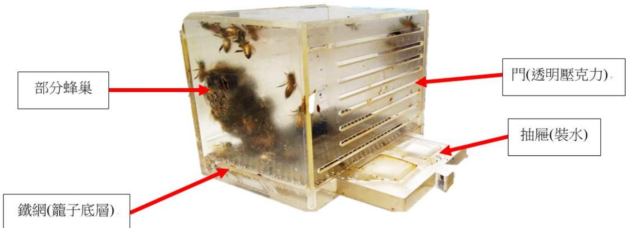
圖二、蜜蜂籠子構造
