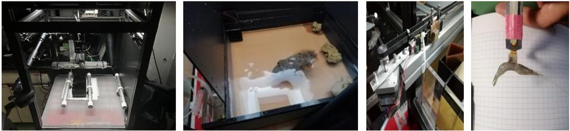
圖三之四：烏賊捕食行為實驗設備。圖左是整個實驗裝置，圖中偏左是壓克力實驗槽(arena)，內有實驗烏賊乙隻，配有石塊，模擬烏賊的天然生態環境。圖中偏右是獵物機械手臂。圖右是獵物機械手臂的鋼條上的吊勾，用來固定蝦子。
