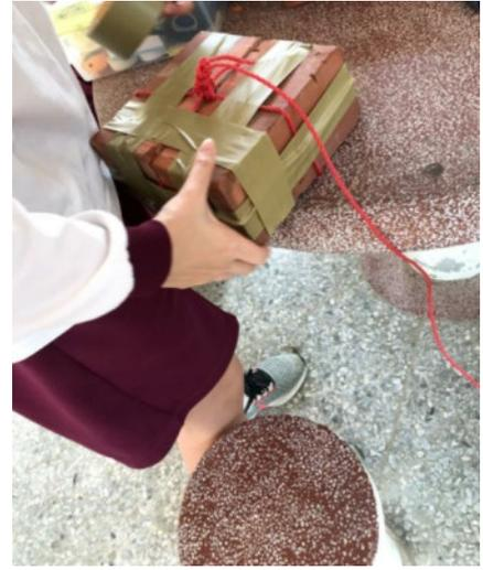
[圖十] 模擬海底崩塌的重物。
