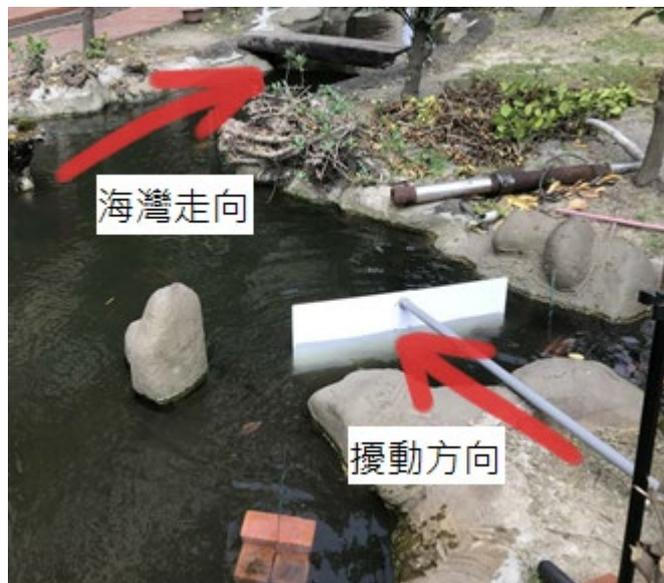
[圖十三(左)、十四(右)] 當斷層破裂與海灣垂直時的實驗裝置
