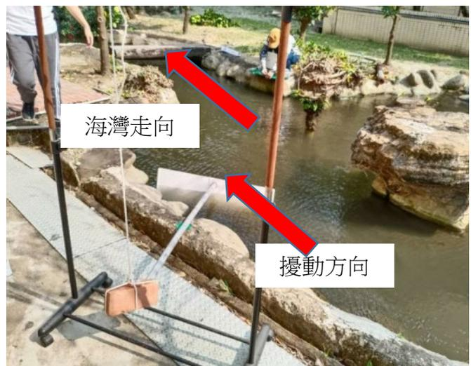
[圖十一(左)、十二(右)]當斷層破裂與海灣平行時的實驗裝置。
