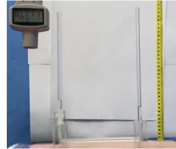
圖七:旋轉中的 U 形管,轉速 111.78rpm。
