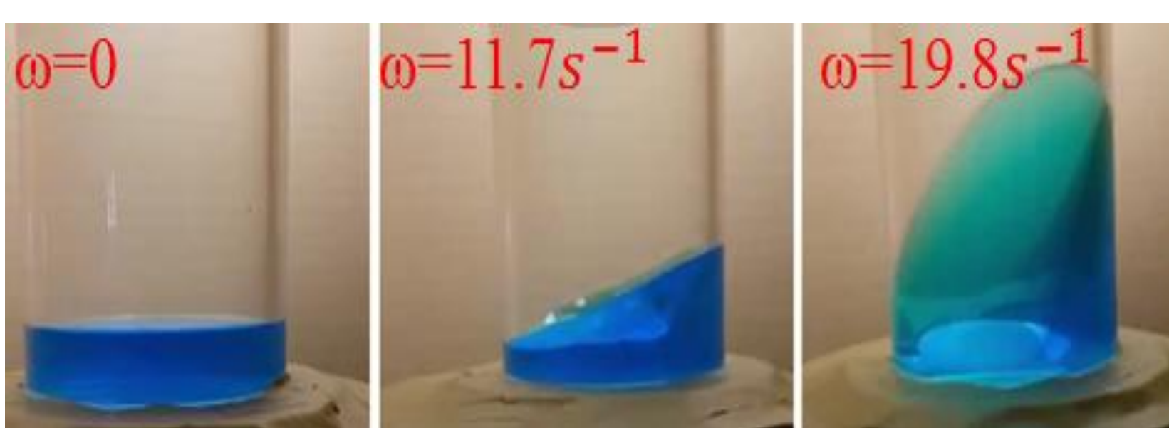
圖十六之1:圓柱筒 a=2.25\text{cm} ，轉動時，液面的變化。
