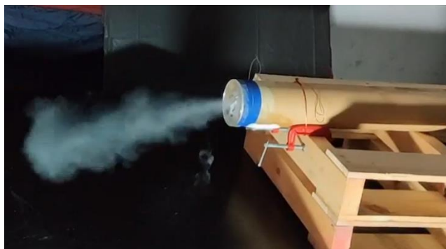
圖 4-7-1 利用乾冰探討氣體流動情形
