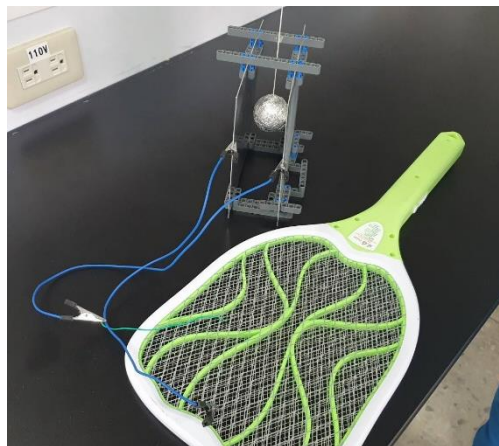
圖 1、實驗裝置說明：以電蚊拍連接平行電板兩端，並以樂高為基座穩固裝置。 (具高電壓低電流特性，且內部具安全裝置)
