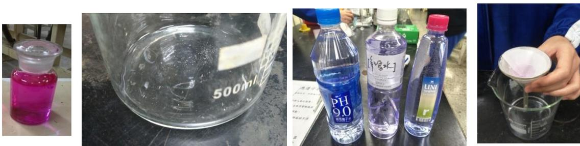
▲圖二(由左至右分別為尼羅紅染劑、塑膠微粒測試樣本、染色後的瓶裝水、以濾紙過濾)
