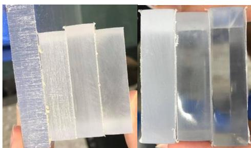
上圖從左而右為尚未切割、100 號的砂紙打磨、400 號的砂紙打磨、800 號的砂紙打磨、使用 800 號的砂紙打磨、使用 1600 號的砂紙打磨、使用 3200 號研磨劑研磨的有機閃爍體
