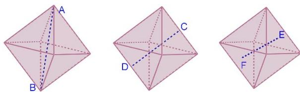
(a) 點到點 (A 到 B) (b) 線到線 (C 到 D) (c) 面到面 (E 到 F)
