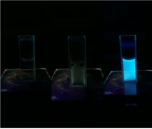
(圖二十) 紫外燈下的水、荖葉粉與經過水熱之荖葉碳奈米點溶液。
