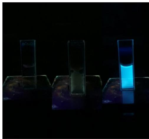
(圖二) 紫外燈下的水、荖葉粉與經過水熱之荖葉碳奈米點溶液
