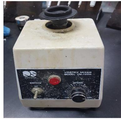
試管振盪器 (圖十二)
