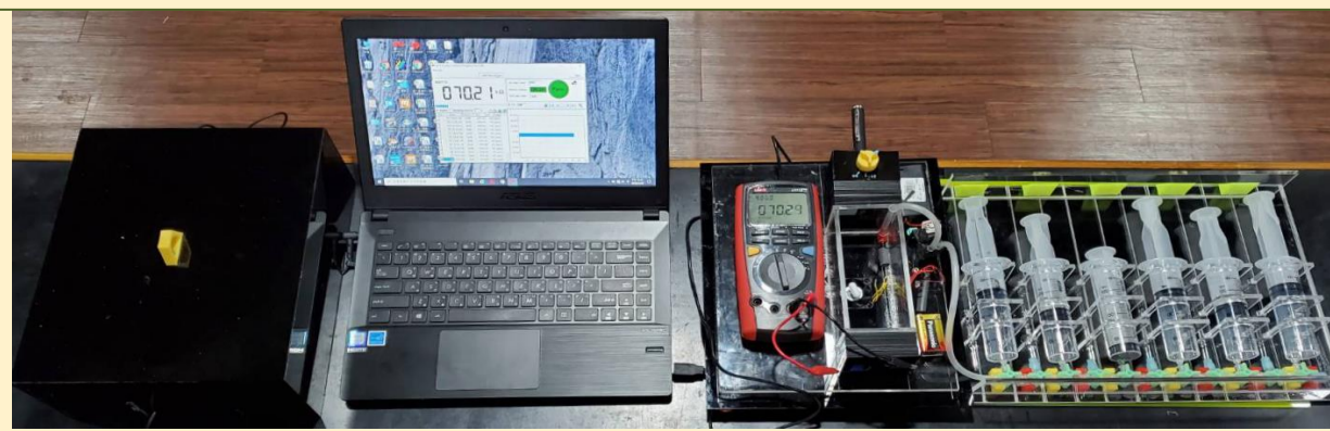
圖 18: 行動式空汙追源裝置-420nm 紫光雷射光度計(中)與薄膜幫浦注射筒氣體收集裝置(右)
