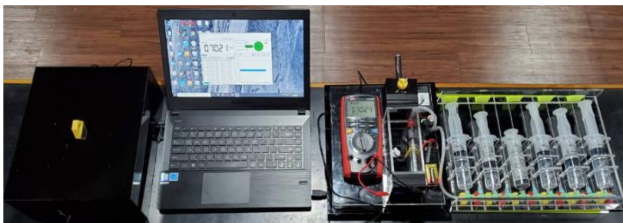
圖 22：自製「行動式 420nm 紫光雷射光度計」與薄膜幫浦氣體收集裝置
