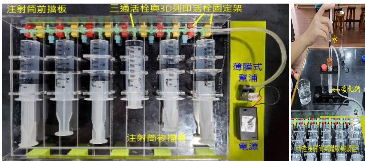
圖 05：搭配薄膜式輸氣裝置的活栓注射筒氣體收集裝置
