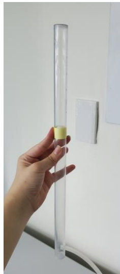
圖 3：40Ds 流速計標記以固定流速
