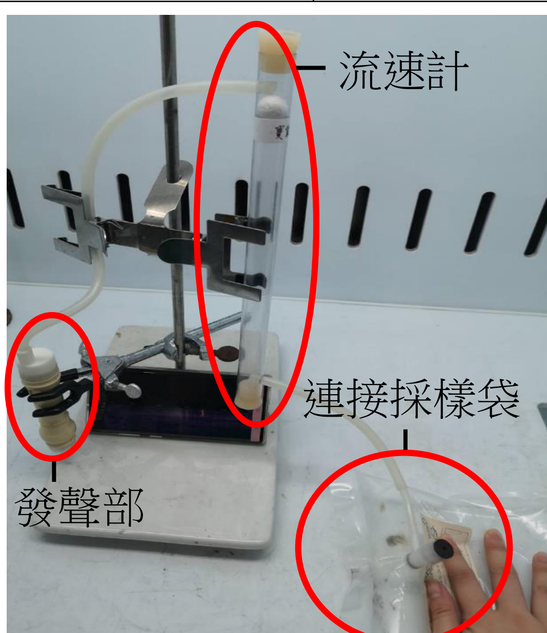
圖3 以N 2 與CO 2 混合氣體進行數值校正
