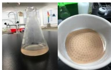
圖 14 變質固體剛加入氫氧化鈉溶液
