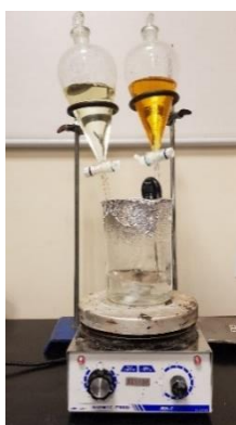
圖 43：磚塊及鋁箔紙保溫裝置 圖 44：製作樣品二裝置 圖 45：以電子溫度計調控溫度
