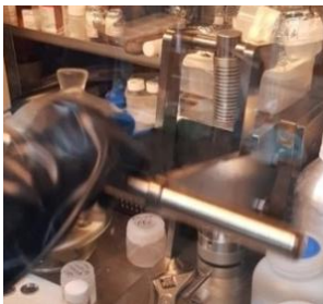
圖 31：油壓式封裝機密封電池
