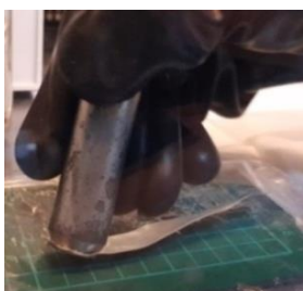
圖 25：壓製 13mm 鋰金屬薄片
