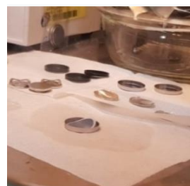
圖 27：隔離膜置於 極片上方
