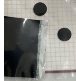
圖 20：完成烘烤的極片 10mm 及 15mm 之圓片
