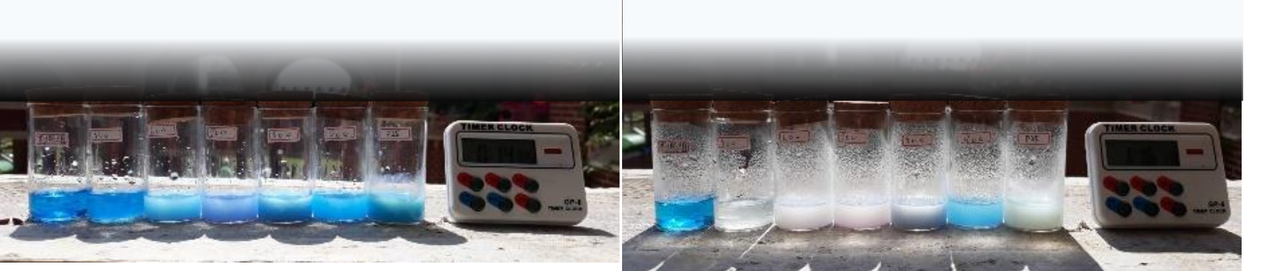
【圖】光催化褪色拍照情形。10分鐘後/60分鐘後
