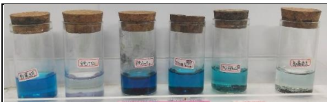
【圖】左而右分別為對照組、自製光觸媒、試藥級 Fe 3 O 4 、TiO 2 (粉)@ Fe 3 O 4 、TiO 2 (檸)@ Fe 3 O 4 、馬齒徒長法。
