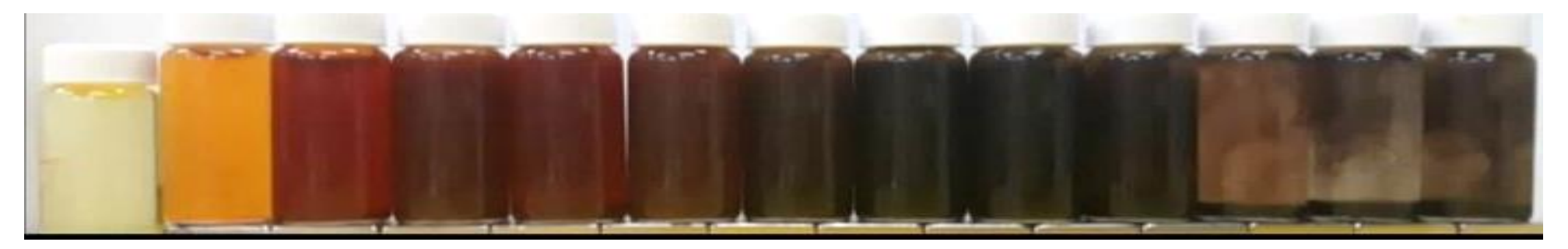
【圖】雙鐵源的沉澱曲線(在Fe 2+ :Fe 3+ =1:2條件下)
