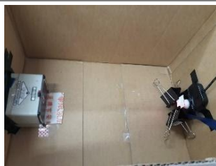
步驟 10-2 使用長尾夾讓薄膜置於照度計前
