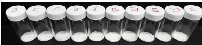
【圖】樹脂/檸檬酸鈦=1/1 在不同 pH 合成的樹脂鈦經燃燒後都可得到 TiO 2 粉末
