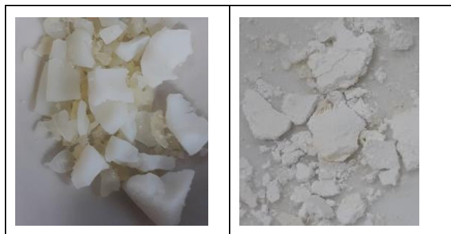
【圖】左為加熱前，右為煅燒後的 \text{TiO}_2
