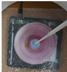
【圖】旋轉塗佈機的操作流程
